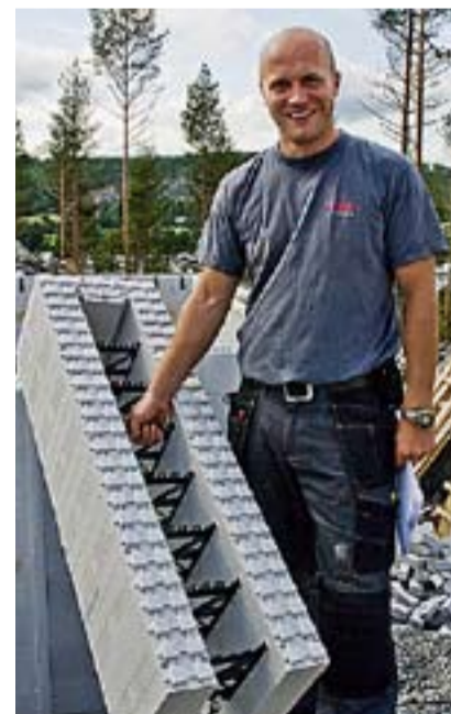
Det vil ikke forundre meg om dette blir fremtidens grunnmur, sier Kjetil Fjeld. Han har satt opp sin grunnmur med slike lette isoporblokker. – Bare å bygge som med Lego. Litt armeringsjern underveis og deretter ferdigbetong. Til slutt må muren pusses. Enkelt og greit, sier han.
