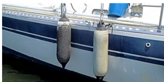
Fenderne – før og etter. Utrolig hva vær og vind i tropiske strøk stiller i stand på bare halvannet år.
